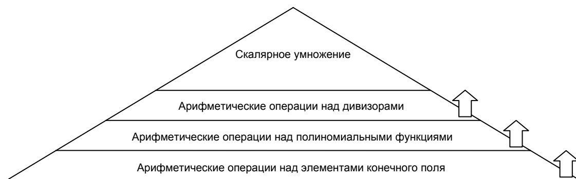
Рис. 6. Обобщенная иерархия операций при скалярном умножении дивизоров в якобиане ГЭК
