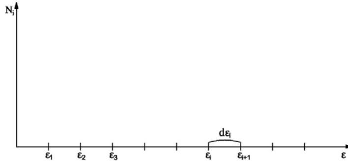
Рис.1.1 Весь спектр энергии от 0 до  $\infty$  разбит на равные малые ячейки шириной  $d\varepsilon$ .  $\varepsilon_i$ - энергетический уровень с номером  $i$ .  $N_i$  – парциальное число заполнения энергетического уровня с номером  $i$ .
